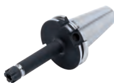
Spannfutter für Spannzangen DIN 6499 (ISO 15488) System ER
